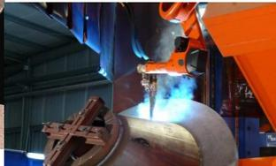
Tandem-Roboter-Kompaktanlage zur Fertigung von Kegelträgern für Schiffsantriebe.
