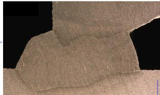
Makroschliff eines einseitig von rechts geschweißten T-Stoßes mit Öffnungswinkel von 30 Grad Celsius.
