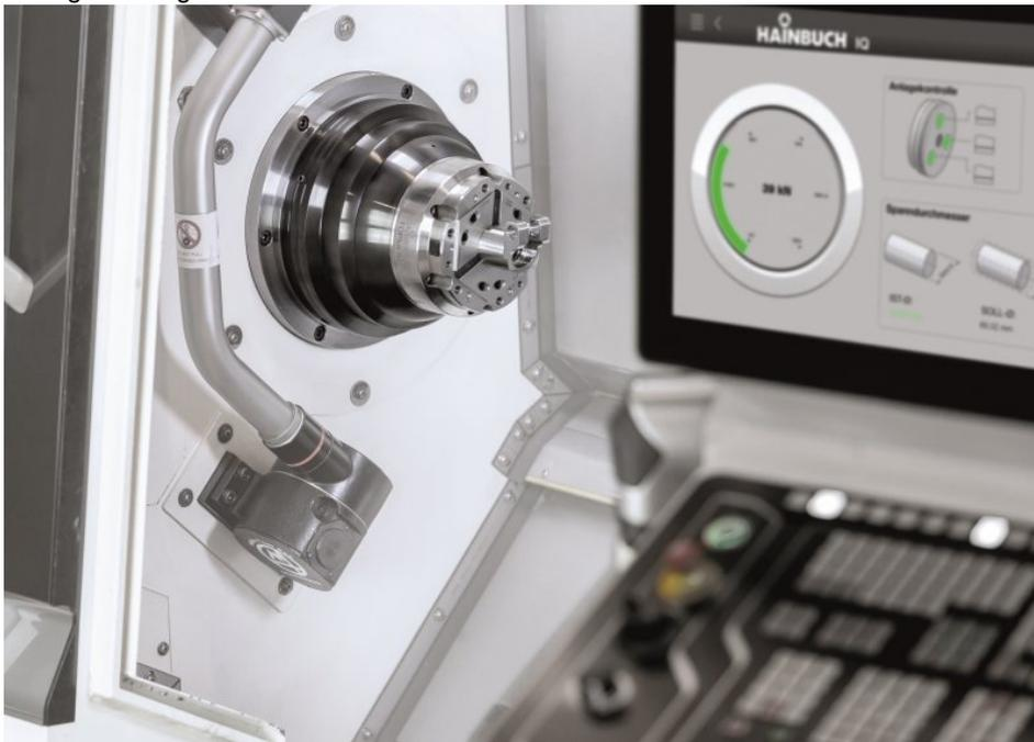
Das Spannfutter Toplus IQ von Hainbuch übernimmt viele Messungen direkt an der Maschine. Bild: Hainbuch
