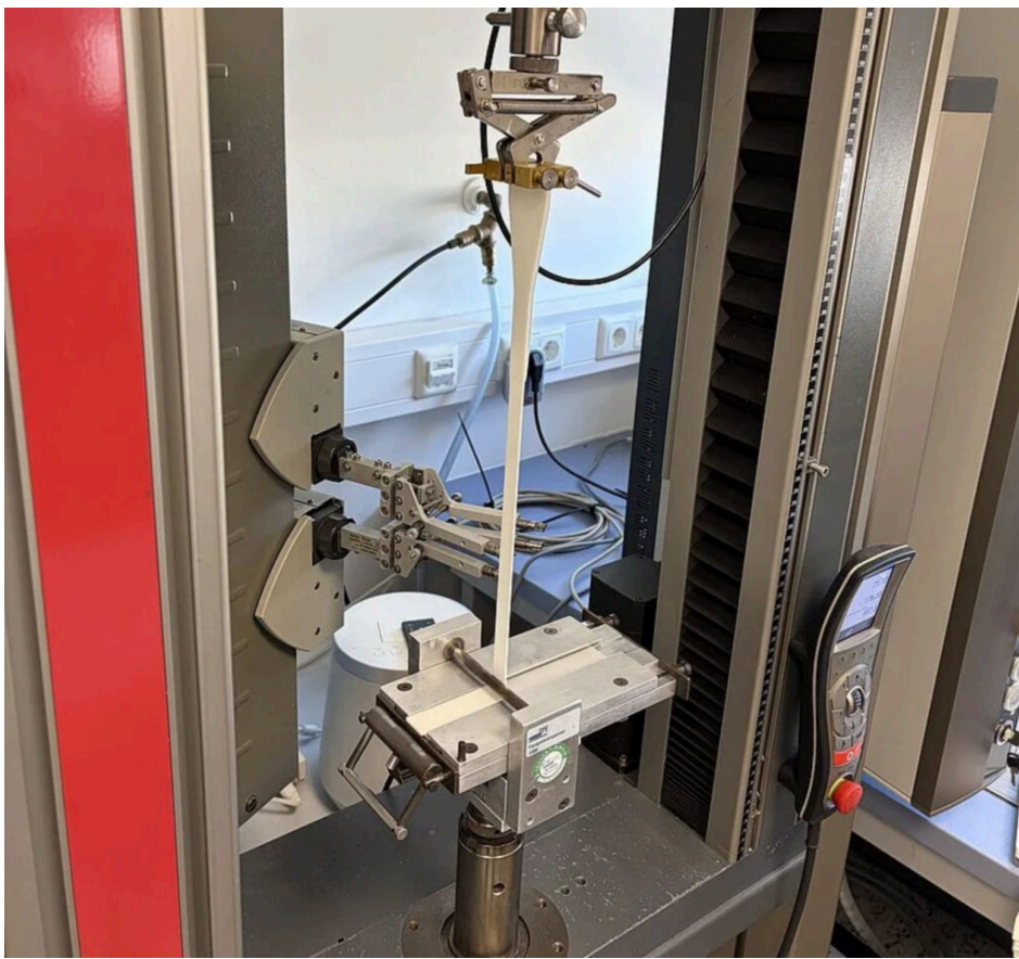
Seitenansicht des eingespannten Prüfaufbaus in einer Materialprüfmaschine für den Abzugversuch. Bild: ZwickRoell
