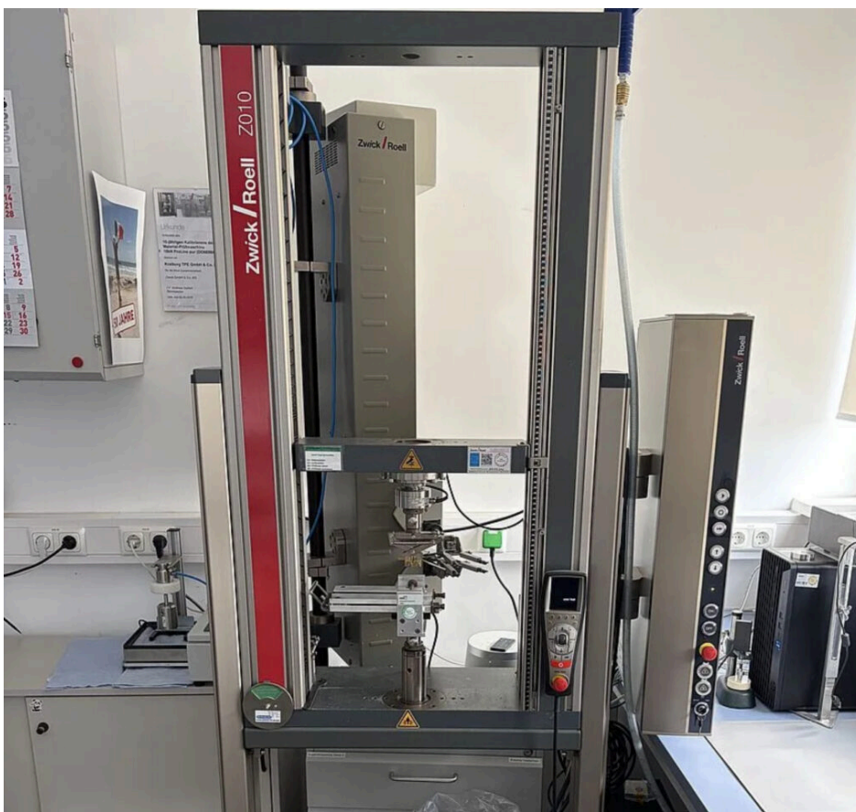
Die ZwickRoell-Lösung zur Haftungsprüfung integriert Prüfschlitten und Messdaten in die Maschine. Bild: ZwickRoell
