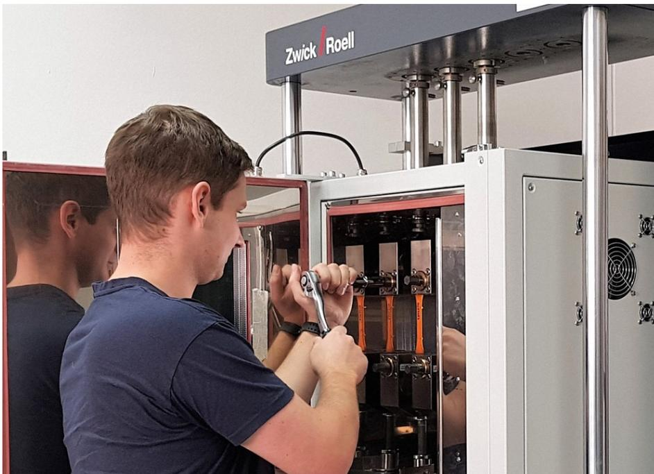
Mit dem Prüfsystem für Stepped Isothermal Method wird das Langzeitkriechverhalten von Polyethylenwerkstoffen bestimmt. Bilder: Zwickroell
