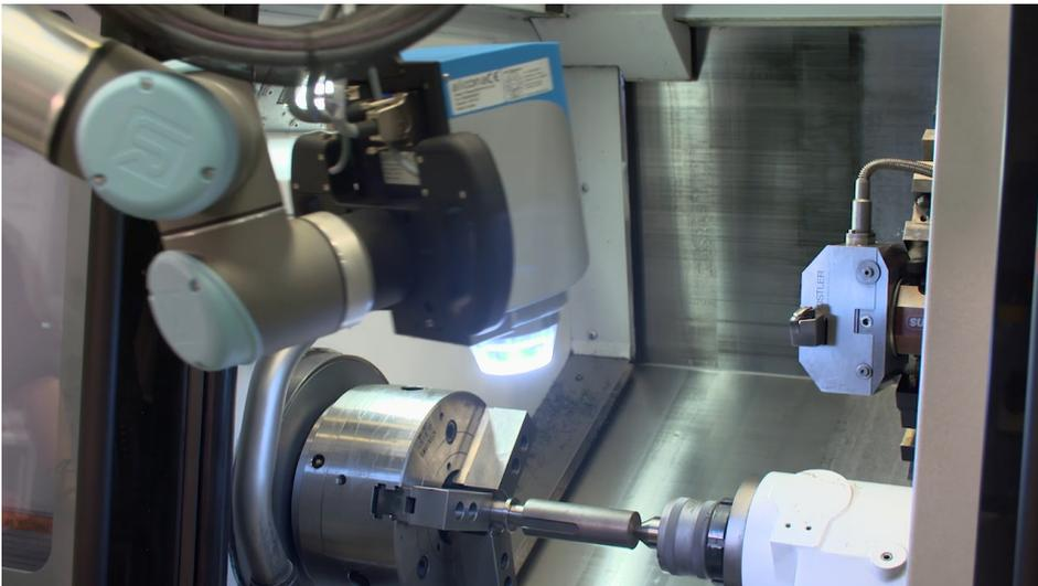
Der Sensor prüft die Oberflächengüte des Werkstücks. Dann wird der Roboter wieder in die Ausgangsposition geführt. Alle Messungen erfolgen ohne Ausspannen der Bauteile. Der Sensor prüft die Oberflächengüte des Werkstücks. Dann wird der Roboter wieder in die Ausgangsposition geführt. Alle Messungen erfolgen ohne Ausspannen der Bauteile. Foto: Alicona
