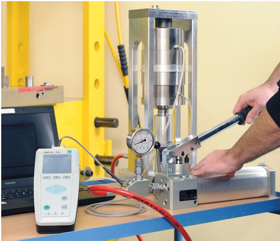
Kalibriergerät im Einsatz für Druckmessertest (Bild: burster)
