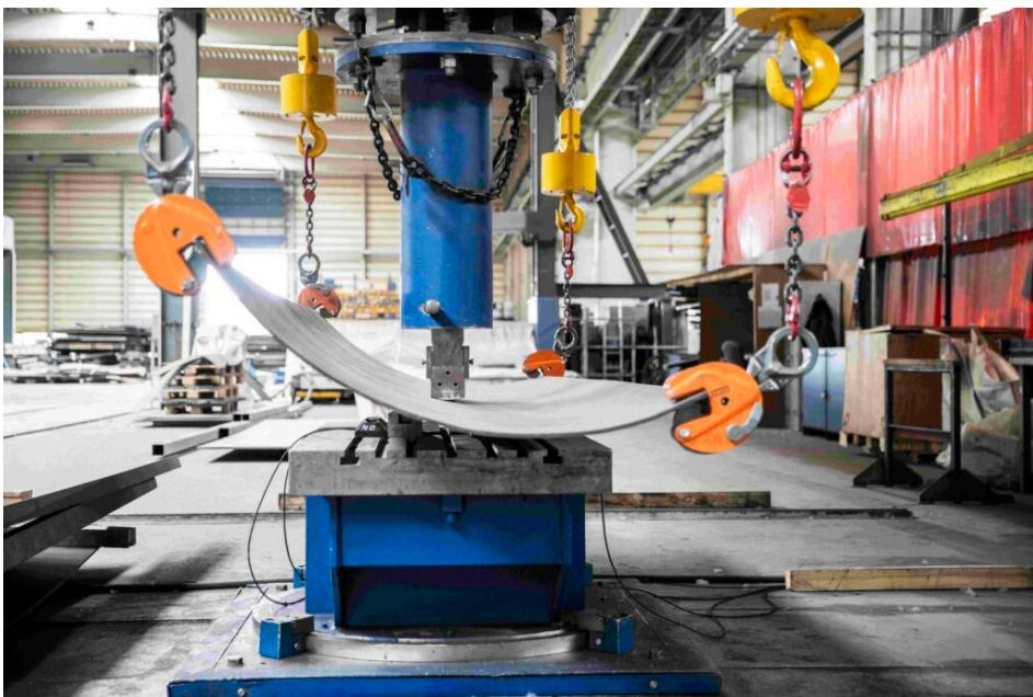
Das 3D-Messsystem ermöglicht den Soll-Ist-Vergleich bei der kaltplastischen Umformung von Stahlblechen in Echtzeit (rechts).
