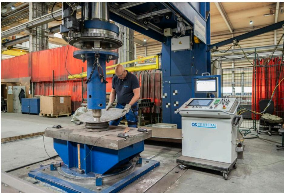
Das Sensornetzwerk besteht aus zueinander synchronisierten Kameras und je einem Projektor zur Musterprojektion für die digitale 3D-Erfassung (links). | Das 3D-Messsystem ermöglicht den Soll-Ist-Vergleich bei der kaltplastischen Umformung von Stahlblechen in Echtzeit (rechts).
