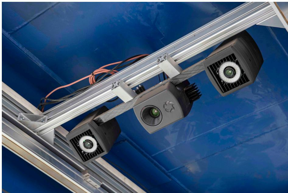
Das Sensornetzwerk besteht aus zueinander synchronisierten Kameras und je einem Projektor zur Musterprojektion für die digitale 3D-Erfassung (links). Bilder: Fraunhofer IOF
