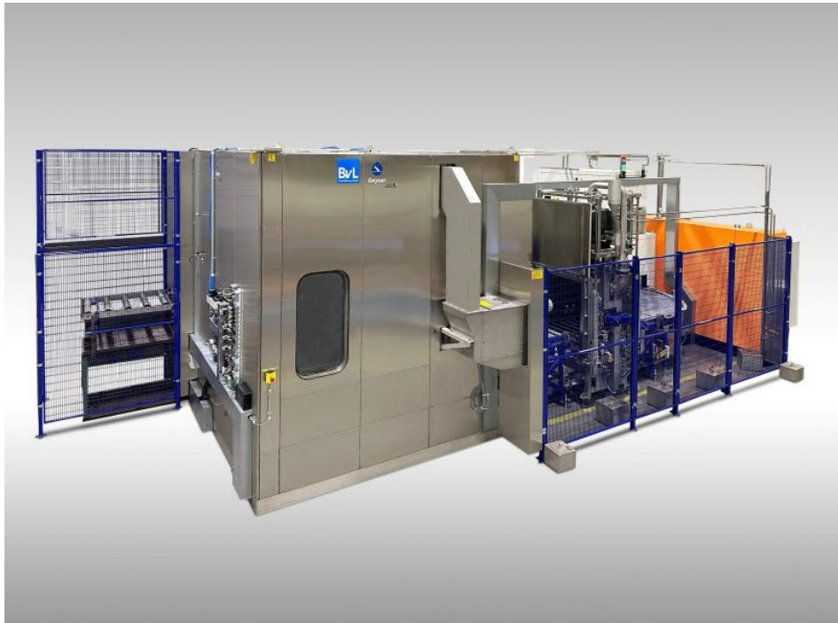
Flexible, modulare Reinigungslösung für große Schwungradgehäuse in der Nutzfahrzeugindustrie (Bild: BvL Oberflächentechnik GmbH)
