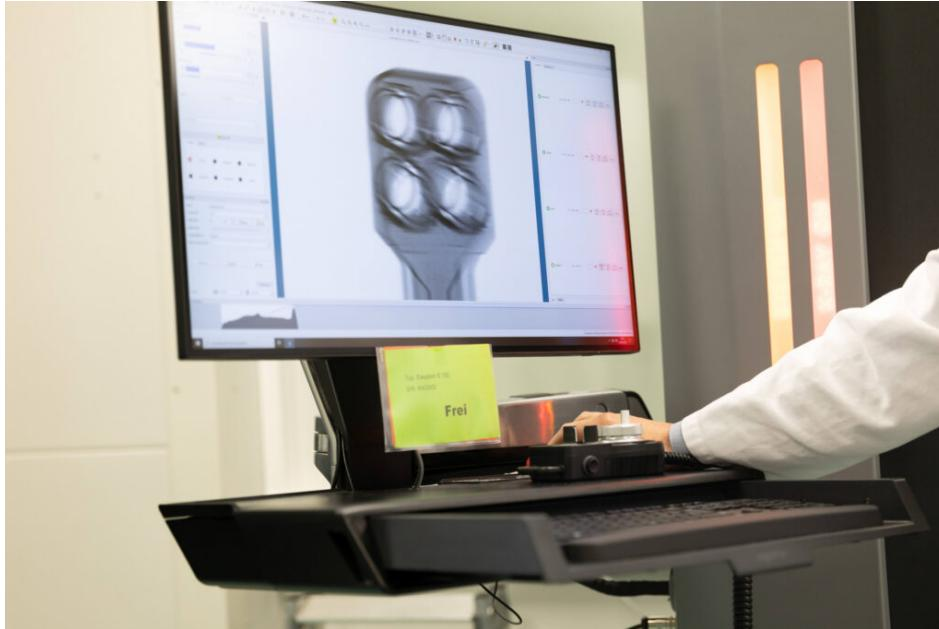
Zentrale Messtechnik: In der Prüfabteilung sichern 24 Koordinatenmessmaschinen von Mitutoyo die Maßhaltigkeit komplexer Kunststoffbauteile.
