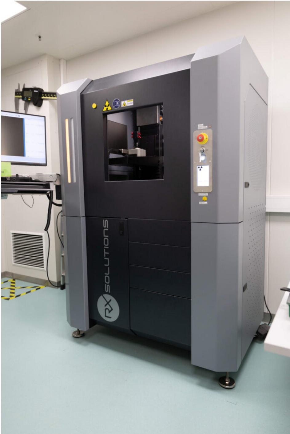
Computertomografie im Einsatz: Das CT-System RX Easytom S von RX Solutions erlaubt die dreidimensionale Analyse und den »Blick ins Bauteil«.
