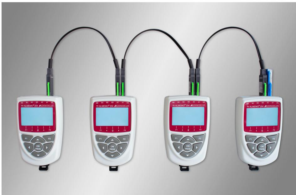
Digitale Almemo-Messtechnik ermöglicht flexible, skalierbare Messnetzwerke, Echtzeit-Datenerfassung und einfache Integration bestehender Sensorik. Bild: Ahlborn
