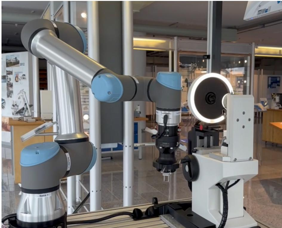
Der Cobot bestückt den Messuhrenprüfplatz vollautomatisch: Das System erkennt verschiedene Prüflinge per QR- oder Datamatrix-Code und positioniert sie präzise.
