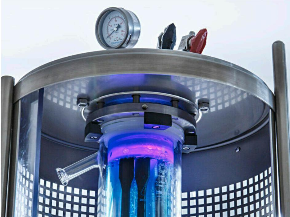
Lebensdaueranalyse unter alkalischen oder sauren Elektrolyseurbedingungen bei erhöhtem Druck und erhöhter Temperatur im Fraunhofer LBF (Bild: Fraunhofer LBF, Raapke)
