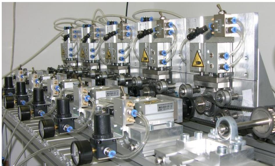
Der Lagerpaket-Prüfplatz ist mit 5 Stationen ausgestattet, so dass zeitgleich bis zu 5 Prüflinge getestet werden können. Aufgrund der Geräuschentwicklung und langen Prüfdauer ist der Prüfplatz sehr gut vom restlichen Prüflabor abgeschirmt. Ein Test dauert i. d. R. zwischen 12 und 14 Wochen.
