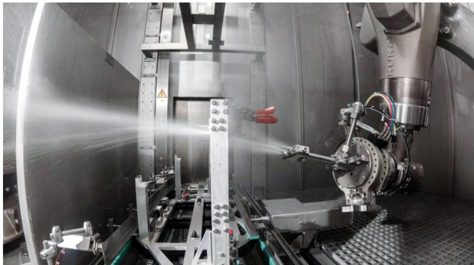
Der Roboter reinigt das an ihm vorbeifahrende Teil. Dieses Prinzip macht die Anlage hochflexibel: Es können unterschiedliche Teile gereinigt werden mit verschiedenen Werkzeugen. Bild: Stefan Woidig
