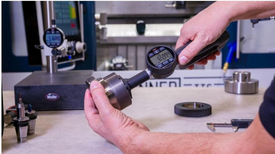
Das digitale 3-Punkt-Innenmessgerät Micromar 844 EWR(i) zur Messung von Innendurchmessern besticht durch seinen ergonomischen Griff mit Rückzughebel für schnelle, selbstzentrierende Messungen über den gesamten Messbereich und das drehbare Display mit Touch-Bedienung. (Foto: Mahr GmbH)
