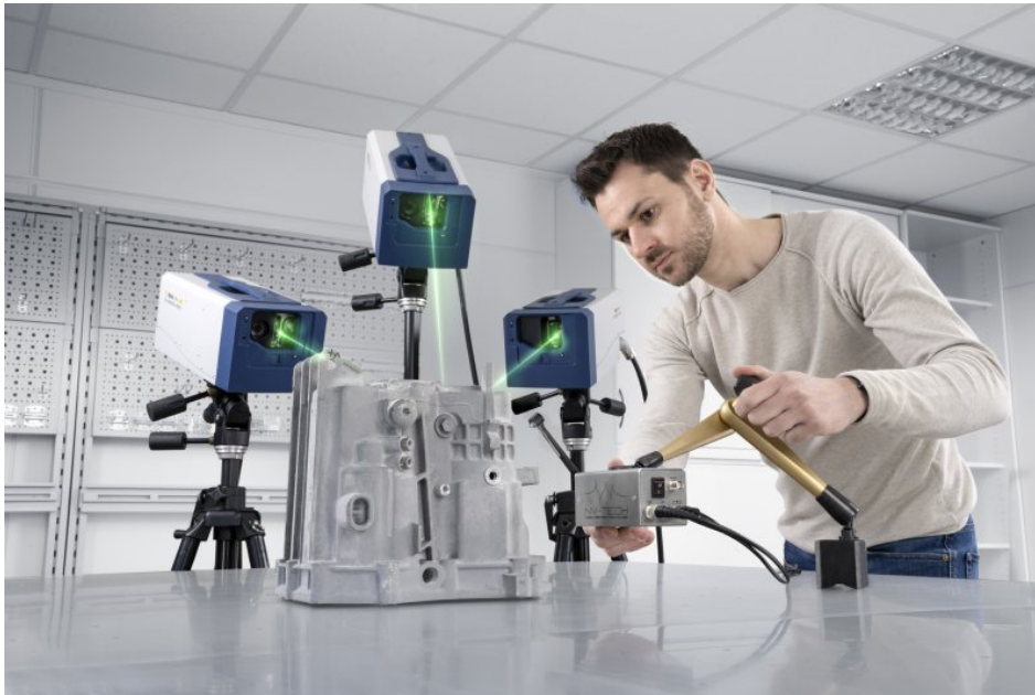
Industrie-Laservibrometer zur Inline-Prüfung in der Produktion (Bild: Polytec)
