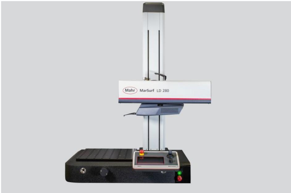
2 in 1: Mit dem Messplatz MarSurf LD 140/LD 280 bietet Mahr eine automatisierte Lösung, um Rauheit und Kontur zur gleichen Zeit und mit höchster Genauigkeit zu messen (Bild: Mahr GmbH)
