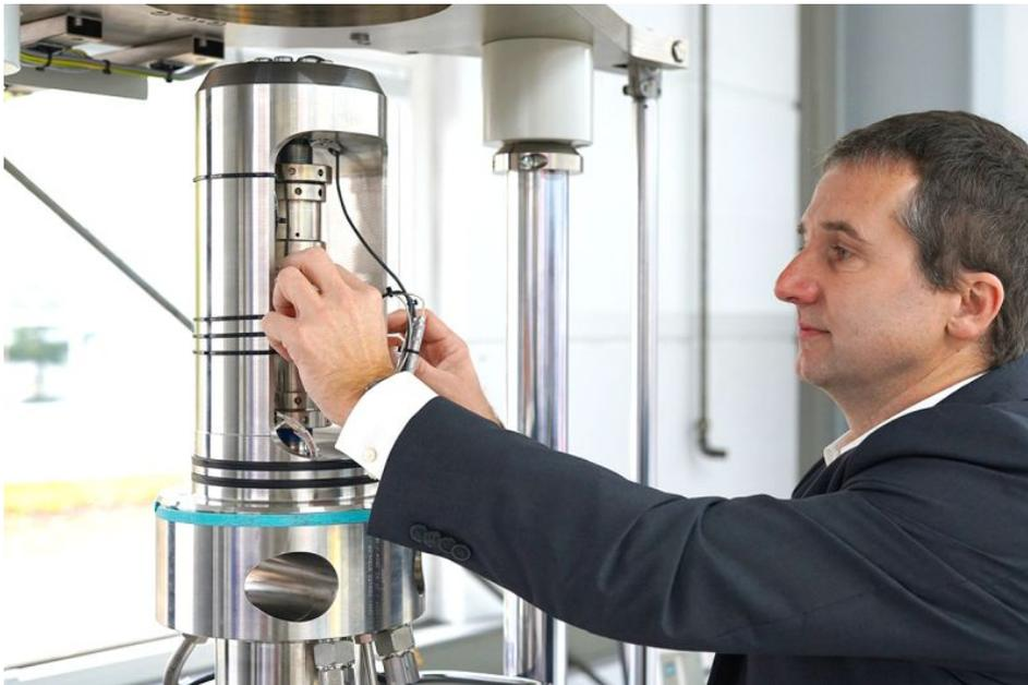
Präzise Werkstoffprüfung unter Wasserstoffeinfluss: Die servohydraulische Prüfmaschine HA 100 von ZwickRoell ermöglicht dem MCL zuverlässige Analysen metallischer Werkstoffe unter realistischen Bedingungen. (Bildquelle: ZwickRoell GmbH & Co. KG)
