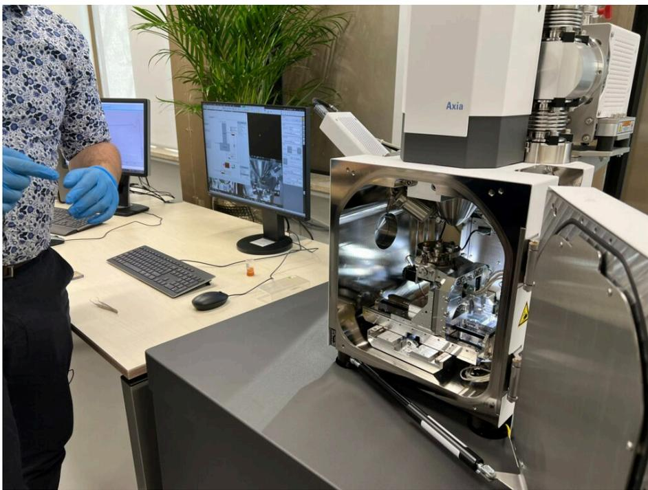
Mit Rasterelektronenmikroskopie können die Hauptelemente und die Zusammensetzung intermetallischer Partikel im Grundmetall untersucht werden.
