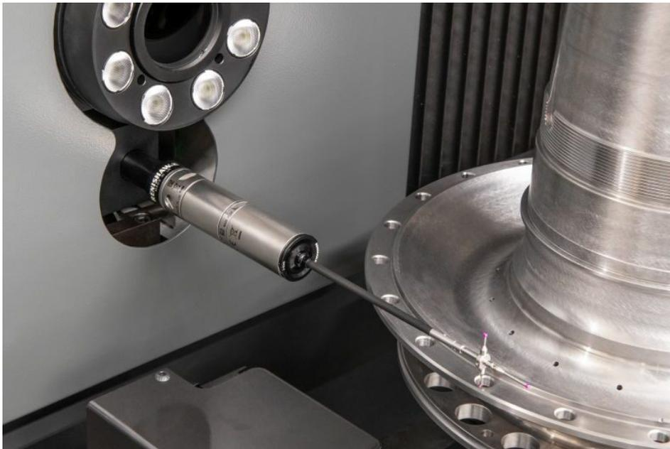
Der neue Multisensor-Messkopf mit Kamera, taktil-scannenden Messtaster SP25 und dem chromatisch-konfokalen Weißlicht-Sensor bildet das Herzstück der neuen Baureihe. (Bild: Schneider Messtechnik)
