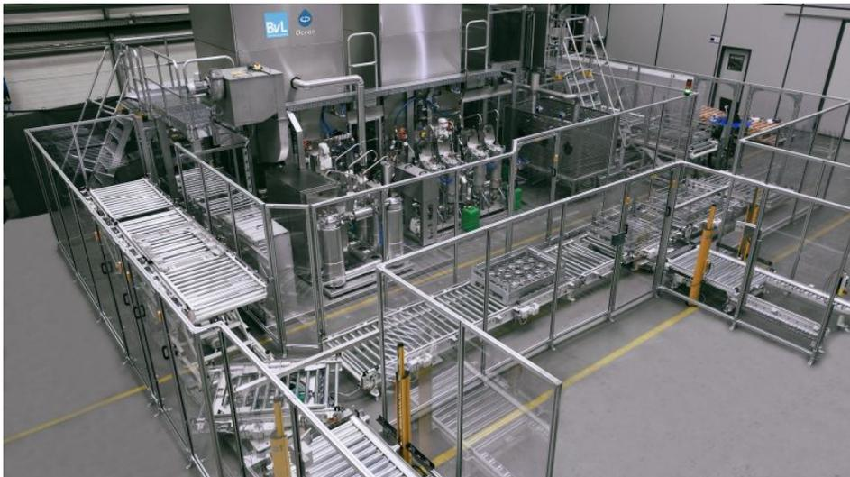
Automatisierte Anlage mit drei Reinigungsstationen in einer Umlaufverkettung mit AGV-Anbindung.
