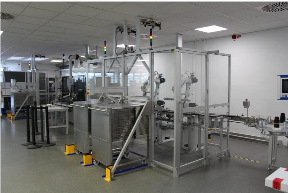
Die Rollwagen werden in den Arbeitsbereich der Roboter geschoben und abgestellt. Ab diesem Zeitpunkt läuft der Prozess autonom.
