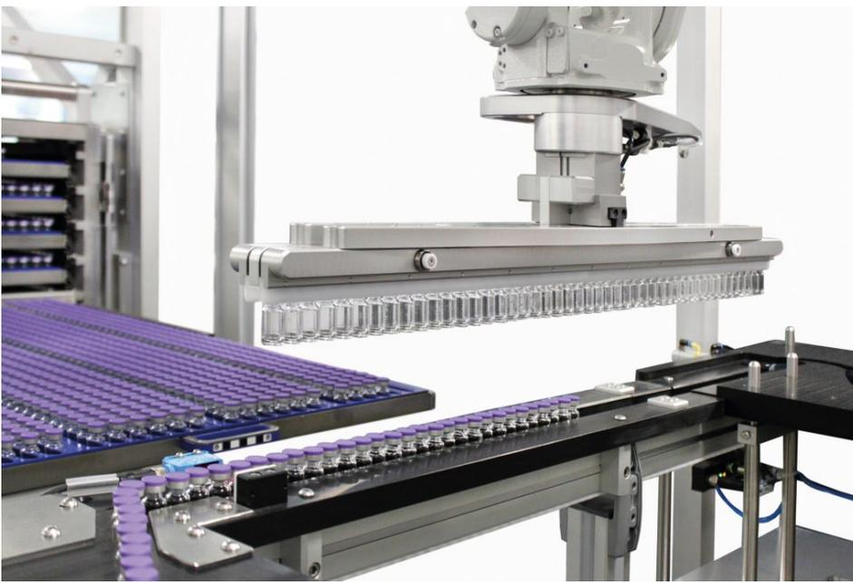
Das Vision-System der Roboterzelle ist so angebracht, dass auf dem Greifer des Roboters keine Kamera angebracht werden muss. Dennoch ist der Roboter in der Lage, bis zu 46 »Vials« exakt zu greifen.
