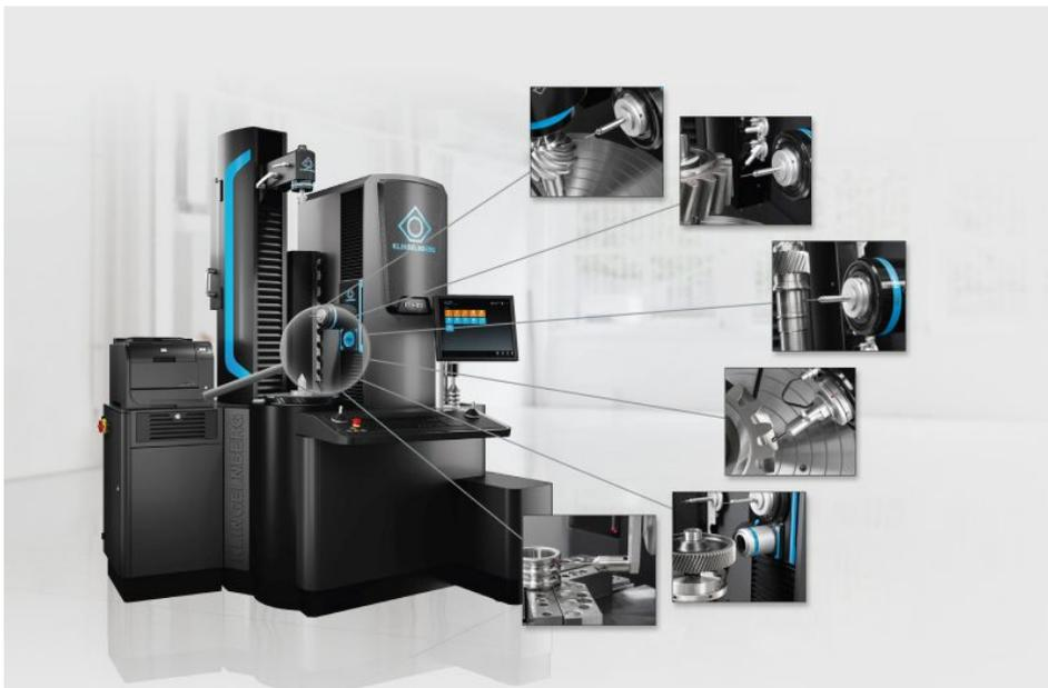
Klingelberg Präzisionsmesszentren integrieren alle Messaufgaben aus den Bereichen der Koordinaten- und Verzahnungsmessung sowie die Form- und Rauheitsmessung auf einer Maschine, die sich produktionsnah einsetzen lässt.
