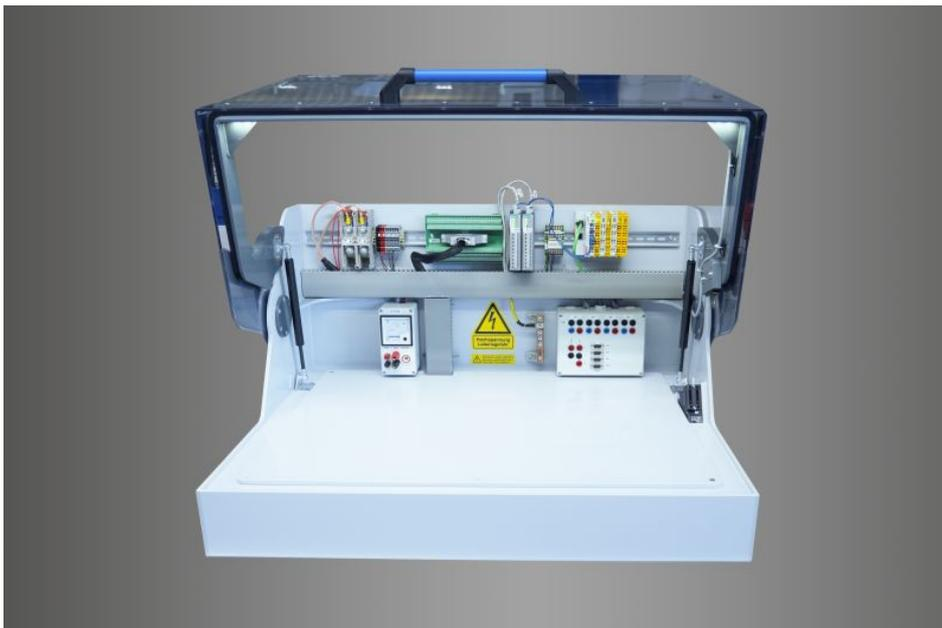
Modulares Testsystem der für Komponenten aus der Leistungselektronik: Damit lassen sich alle erforderlichen Messungen bereits vorab durchführen.
