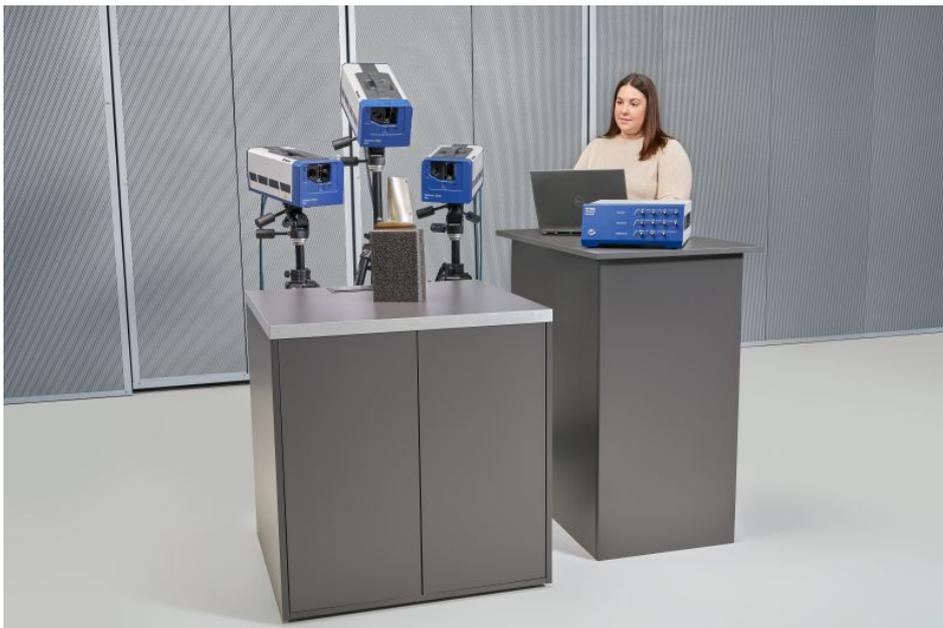
Aus 3 mach 1: VibroScan QTec in der 3D-Konfiguration ermöglicht synchronisierte Triax-Schwingungsmessungen für Modalanalyse, Dehnungsmessung und NDT
