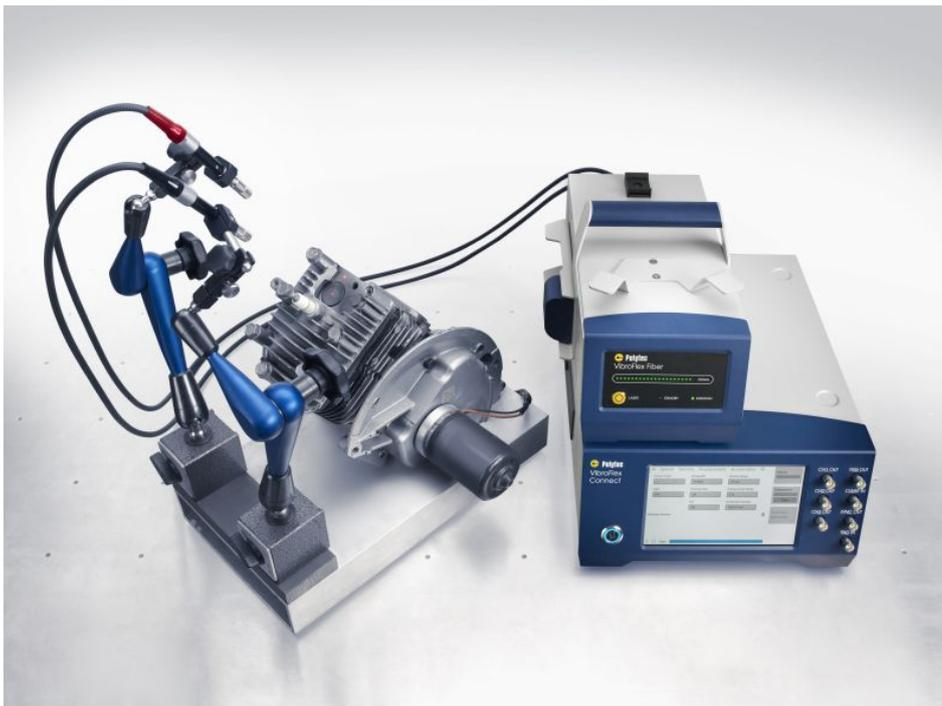
VibroFlex Fiber zur differenziellen Schwingungsmessung mit zwei Messpunkten (Bild: Polytec)
