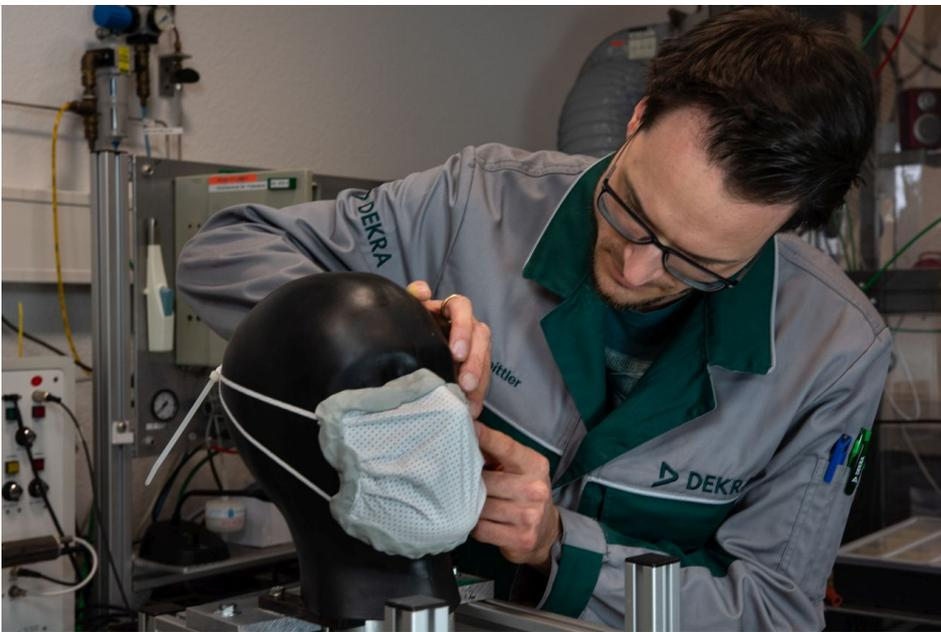
Dekra prüft bereits die ersten Muster von Schutzmasken mit dem erarbeiteten Prüfgrundsatz im Labor in Essen. Bild: Dekra
