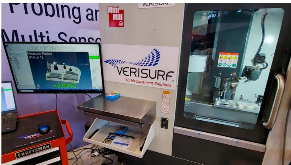
Die Machine Tool Probing (MTP) Suite wurde entwickelt, um die In-Prozess-Prüfung direkt an CNC-Werkzeugmaschinen zu unterstützen (Bild: Verisurf).
