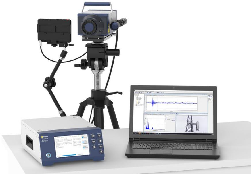
Bei diesem Laservibrometer verbessert die »QTec«-Technologie das Signal-Rausch-Verhältnis bei Schwingungsmessungen signifikant.
