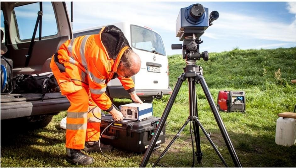
Für den Außeneinsatz konzipiert und in wenigen Minuten einsatzbereit ist der Laservibrometer.
