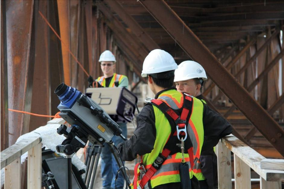
Strukturdynamische Untersuchung an Brücken: Verschiebungen und Eigenfrequenzen werden zeit- und kosteneffizient erfasst.
