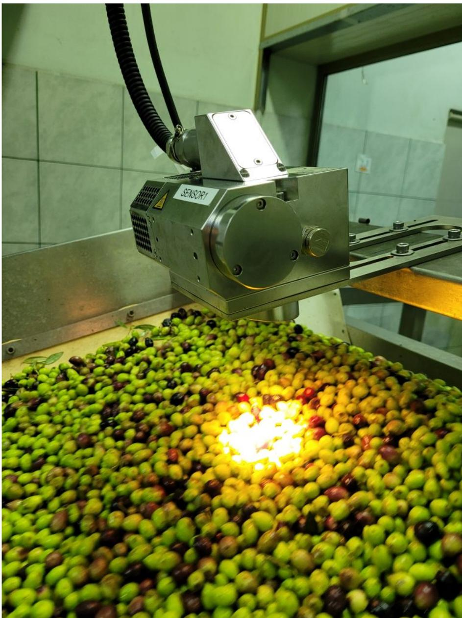
Zur Bestimmung von Feuchtigkeit und Ölgehalt ist der Distanzmesskopf über dem Förderband mit den Oliven montiert.
