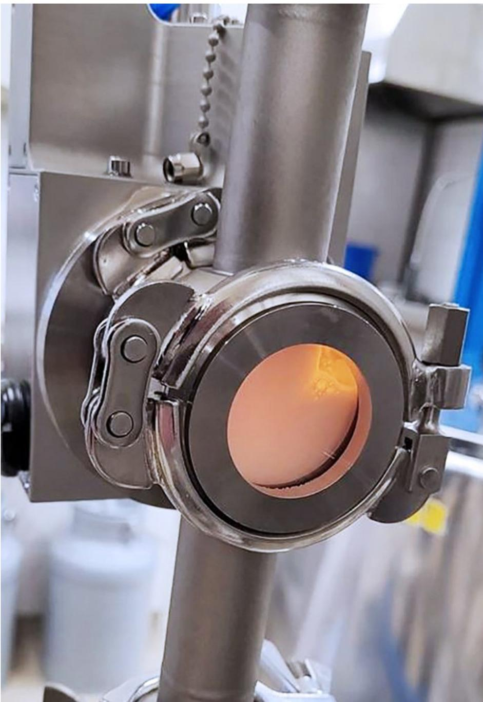
Ein Kontaktmesskopf direkt in der Pumpleitung ermittelt kontinuierlich den Fett- und Eiweißgehalt bei der Trinkmilch-Produktion.
