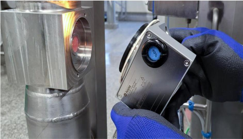
Die Inline-Analyse von Fett-, Eiweißgehalt und Feuchte sorgt bei der Herstellung von Fleischprodukten für eine konstante Produktqualität. Bilder: Polytec
