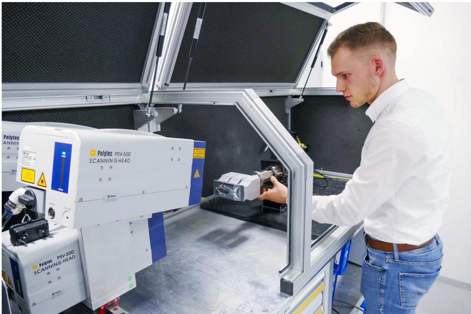
Laservibrometer von Polytec können dank ihrer Automatisierungsschnittstelle einfach in Produktionslinien für die vibroakustische Qualitätskontrolle integriert werden (Bild: Polytec).
