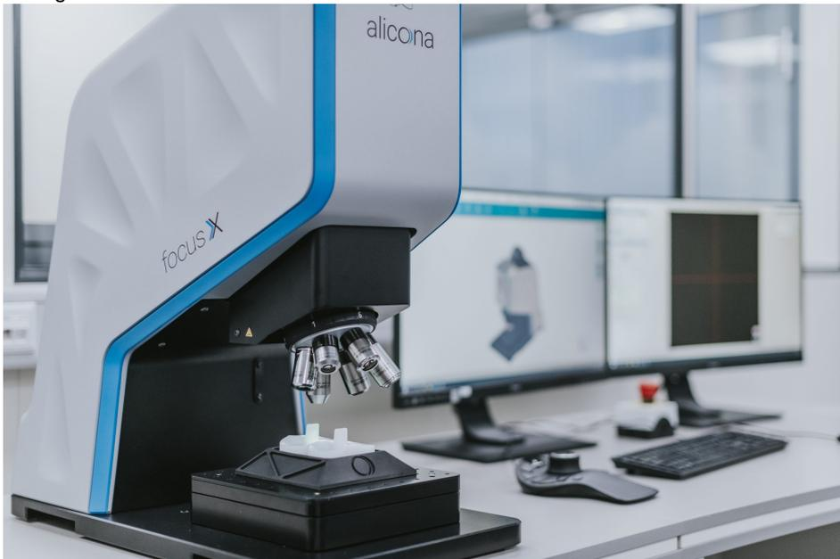
Mit einem einzigen Klick kann der Anwender eine ISO-konforme Rauheitsmessung durchführen (Bild: Bruker Alicona).
