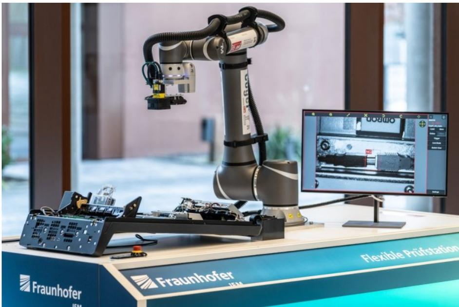
Die KI-gestützte Bildauswertung ist direkt im Kameramodul des Roboterarms integriert (Bild: Fraunhofer IEM / Janosch Gruschczyk).
