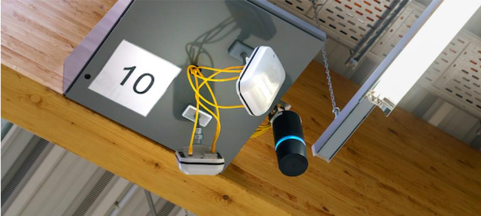
Deckenantenne für die Lokalisierung.
