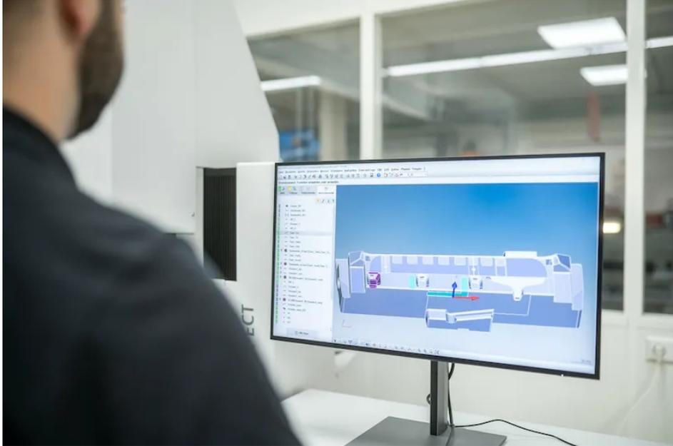
»Zeiss CALYPSO« ermöglicht das Programmieren des Messgeräts in Kombination mit dem 3D-Modell.
