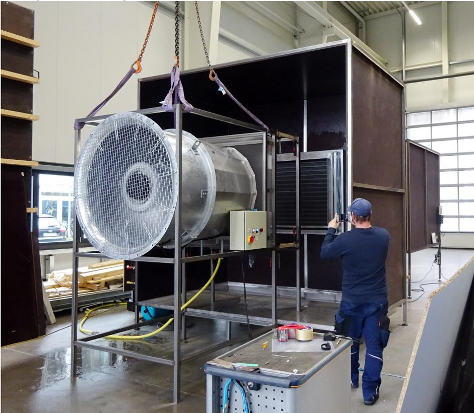
Das Prüfzentrum für Bauelemente in Stephanskirchen entwickelt Prüfvorrichtungen für komplexe Sonderprüfungen. Bei dieser Prüfung werden Gitter für Belüftungssysteme oder Wärmetauscher auf Wasserdurchschlag getestet. Bilder: PfB
