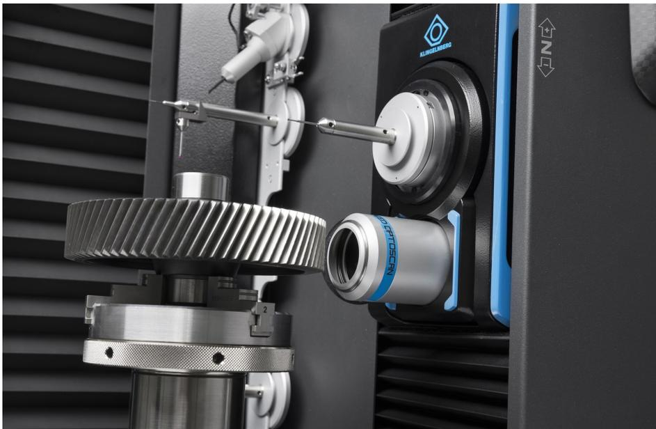
Klingenberg kombiniert die optische Messtechnik mit dem hochgenauen taktilen Tastsystem. Bild: Klingenberg
