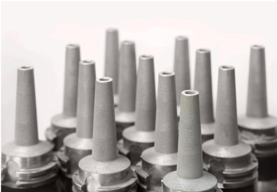
Durch den Einsatz des additiven Verfahrens hat Mapal die Temperaturbeständigkeit und Geometrie des Hydrodehnspannfutters optimiert. Foto: Mapal
