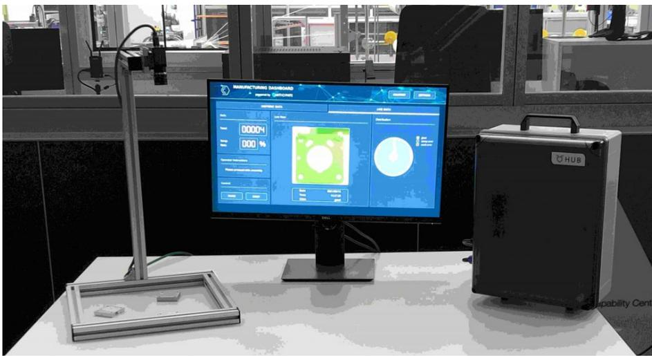
Die kamerabasierende Qualitätskontrolle dient zur Beurteilung von Druckfehlern.
