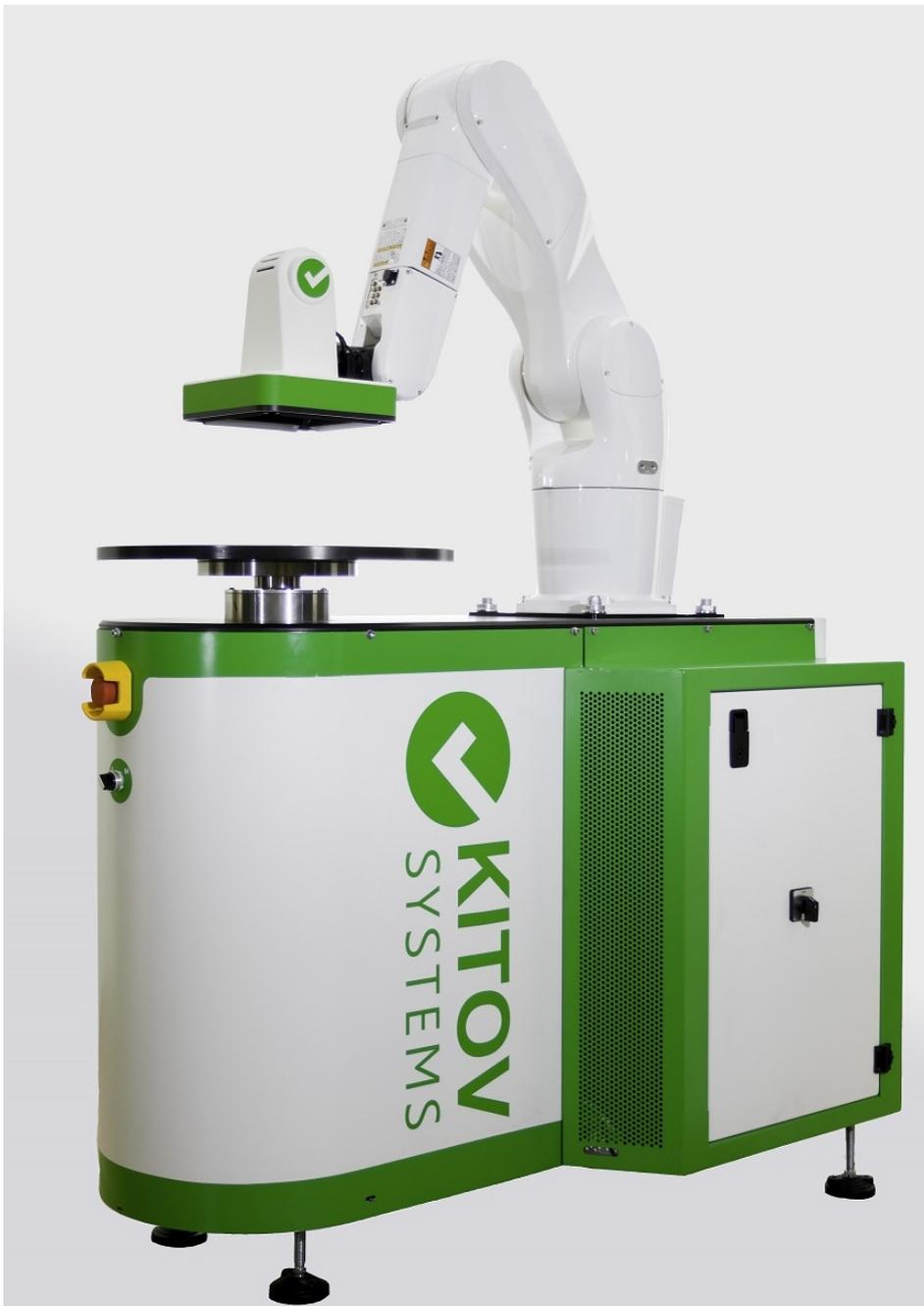
Überspritzungen, Weißbruch oder Ungenauigkeiten werden vom Kitov One zuverlässig erkannt. Bild: Atecare
