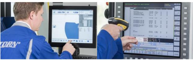
Die Bedienung ist besonders einfach gehalten: Das Fadenkreuz springt automatisch an die zu messende Stelle. Relevante Werte werden direkt angezeigt.
