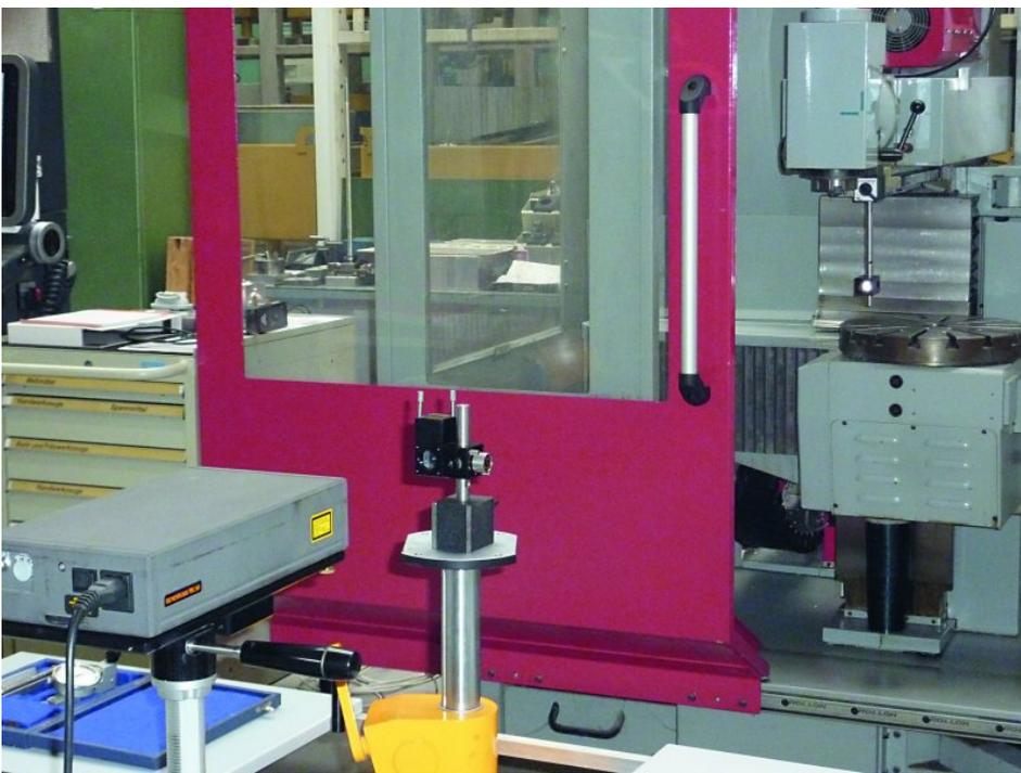
Werkzeugmaschinenanalyse mit Laserinterferometer: Aus der Analyse der Daten lassen sich Modelle erstellen, mit denen die Werkzeugmaschinen optimiert werden können (Bild: Jens Dettmann/Hochschule Wismar).
