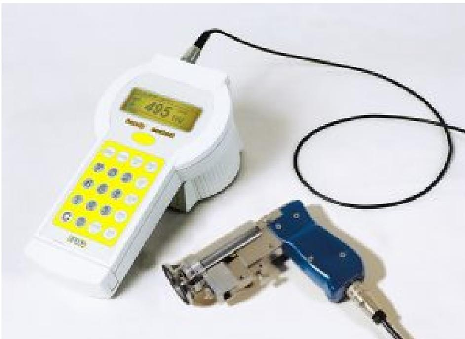
Tragbares Härteprüfgerät zur Prüfung von großen Bauteilen.
