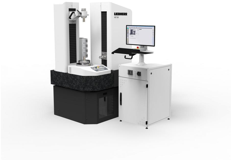
Geläppte Granitführungen und Luftlagerung sorgen bei den Maschinen der Wenzel Geartec für dauerhafte Präzision. Bild: Liebherr
